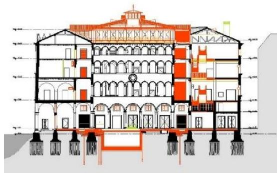
Рис. 3, 4. План и разрез Фондако-деи-Тедески (Немецкий двор). Желтым цветом выделены демонируемые части, красным – дополнения при реновации. Чертежи ОМА, 2016 г. [21]
